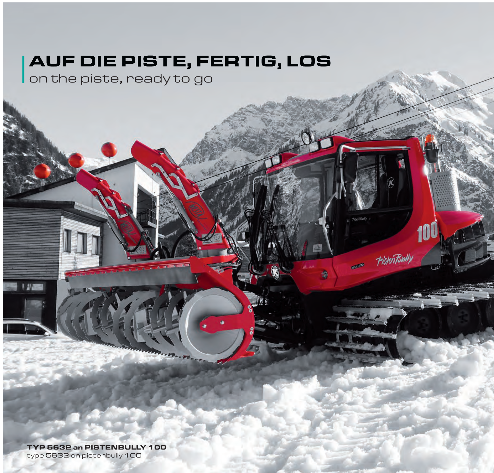
FRÄSE 6546 Breite 4,6 Meter Snow blower width 4.6 meters
